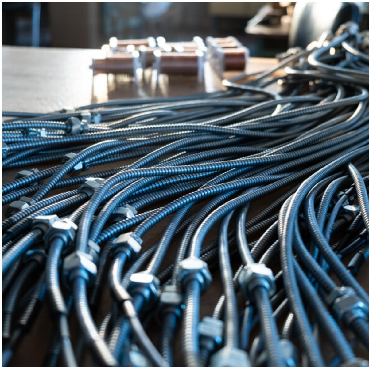
Tubería metálica flexible elaboradas con flejes de acero galvanizado, recubiertas en PVC LIBRE DE HALOGENOS con FILTRO UV. Fabricada de acuerdo a las normas IEC 61386-21 e IEC 61386-23. Canalización de sección circular preformada y enrollada, resistente a líquidos y sustancias químicas, con propiedades aislantes, autoextinguible, no propagante a la llama.
